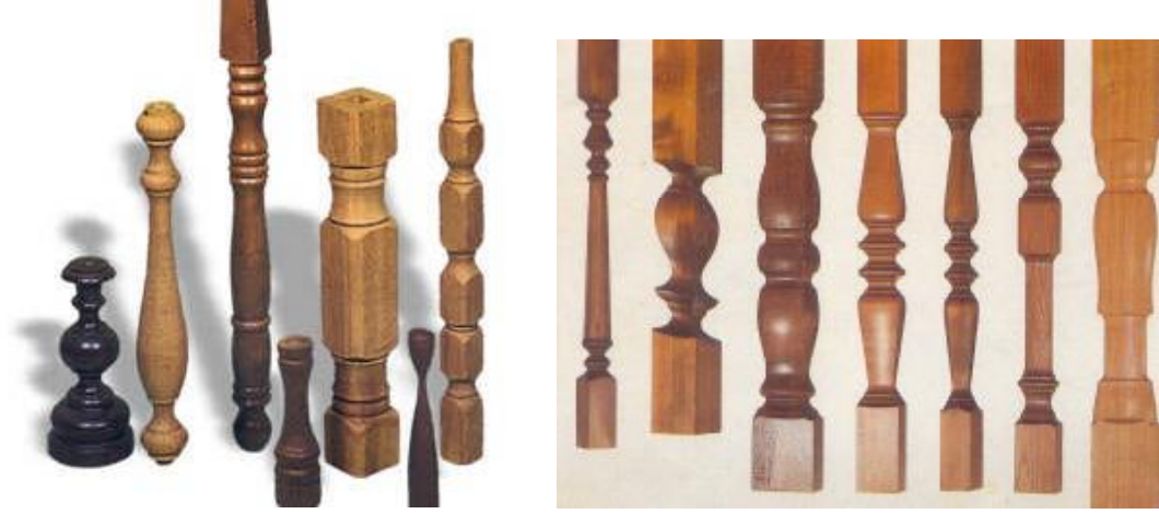
Resim 2.2: Manüel torna makinesinde yapılan bazı çalışmalar
