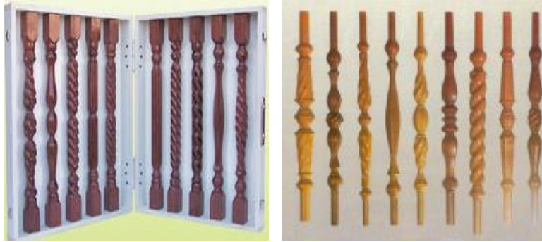
Resim 2.11: Dekoratif burma makinesinde yapılan bazı çalışmalar
