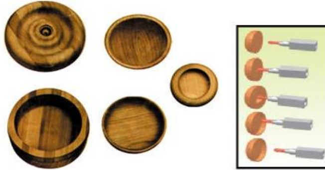
Resim 2.7: Yüzey işleme ve iç boşaltma tornasında yapılan bazı işler ve torna bıçakları
