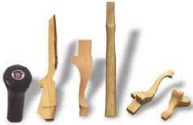
Resim 2.9: Eksantrik kopyalama makinesinde yapılan bazı çalışmalar
