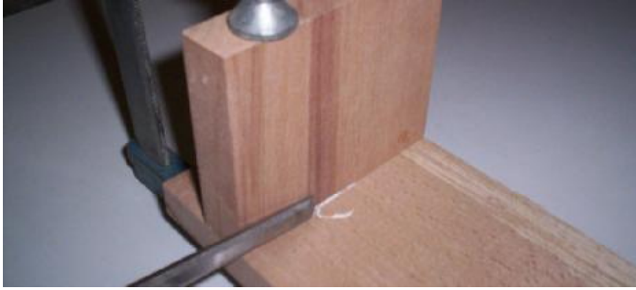
Resim 1.5: Sıkıldıktan bir süre sonra temizlenen PVA tutkalı
