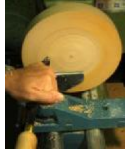
Resim 1.17: Kazıma yöntemiyle alın tornalama yapmak
