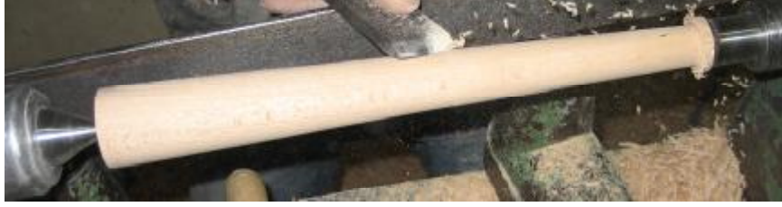
Resim 2.4: Düz konik şekil vermek
