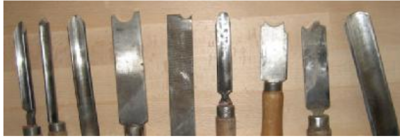
Resim 3.3: Ağzı değişik biçimlerde şekillendirilmiş bıçaklar
