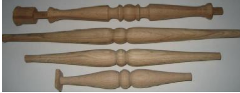
Resim 2.2: Konik tornalanmış simetrik parmaklıklar
