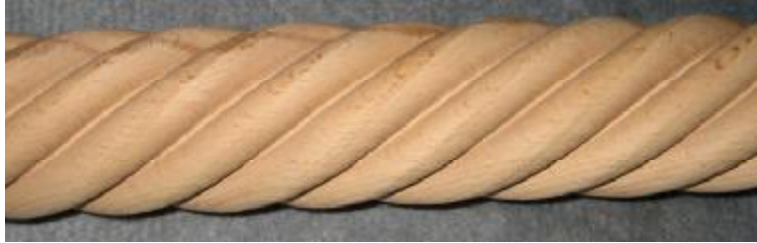
Resim 4.4: Yüzeysel bir burma uygulaması, bıçak yüzeysel kalmış
