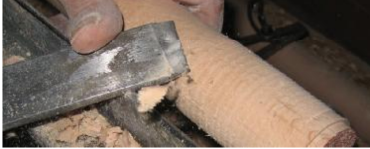
Resim 1.13: Kesme yöntemiyle tornalama yapmak
