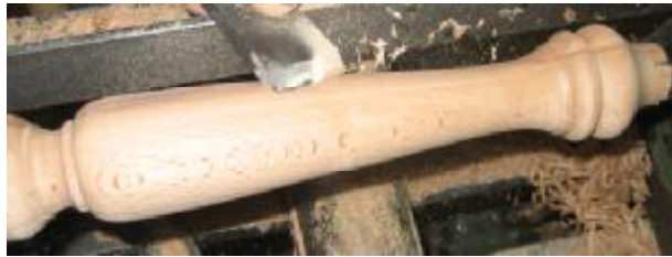
Resim 2.6: Konik kademeli tornalanmış bir sehpa ayağı
