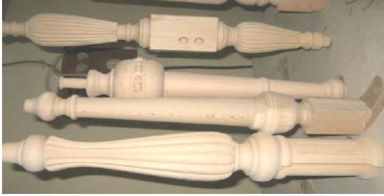
Resim 2.8: Değişik şekillerde tornalanmış ve muz dilimi fitil açılmış ayaklar
