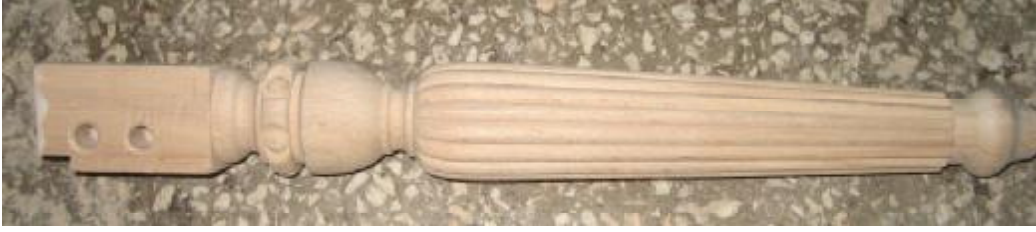
Resim 2.7: Konik kademeli tornalanmış ve üzerine Muz dilimi fitil açılmış bir ayak
