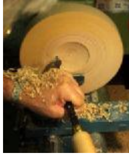
Resim 1.17: Kazıma yöntemiyle alın tornalama yapmak
