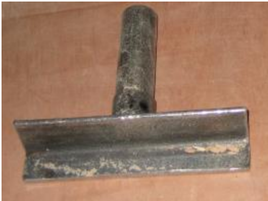
Resim 1.5: Kısa L profil ve kaynaklı siper
