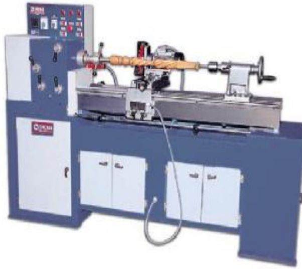
Resim 4.3: Geliştirilmiş bir burma torna makinesi
