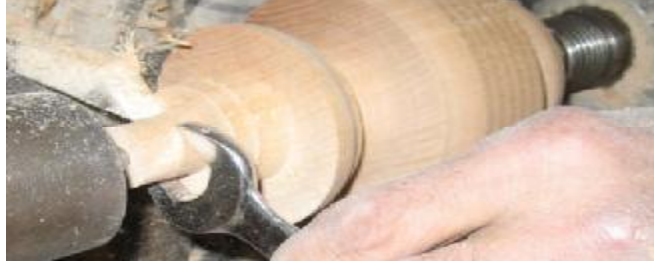
Resim 1.16: Kazıma yöntemiyle ölçüye getirmek
