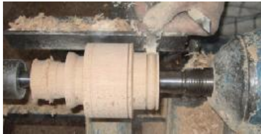
Resim 1.15: Kazıma yöntemiyle şekil oluşturmak
