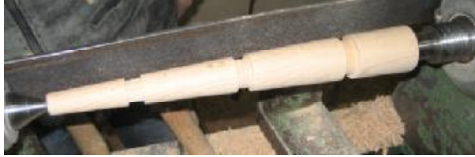
Resim 2.5: Konik kademeli tornalanmış bir iş
