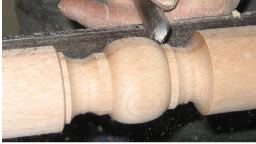
Resim 3.2: İçbükey ve dışbükey tornalama
