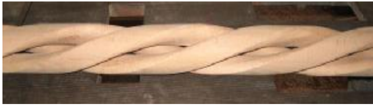
Resim 4.5: İçi boş bir burma uygulaması, bıçak merkeze kadar girmiş
