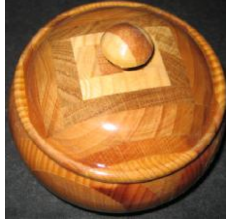
Resim 1.8: Parçaların çevresel olarak üst üste yapıştırılması ve elde edilen kompozisyon
