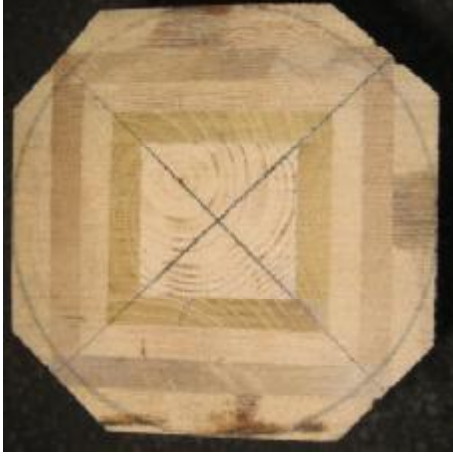
Resim 1.8: Parçaların çevresel olarak üst üste yapıştırılması ve elde edilen kompozisyon
