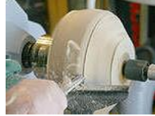
Resim 1.14: Alın tornalanacak parçaların puntalar arasına bağlanması
