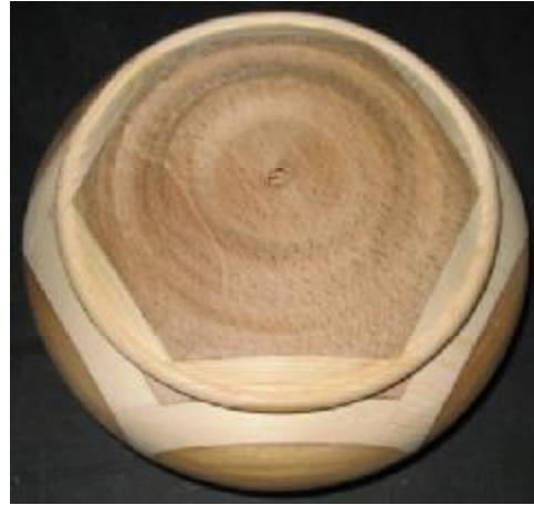
Resim 1.9: Parçaların altıgen bir parça çevresine üst üste yapıştırılması ve elde edilen kompozisyon
