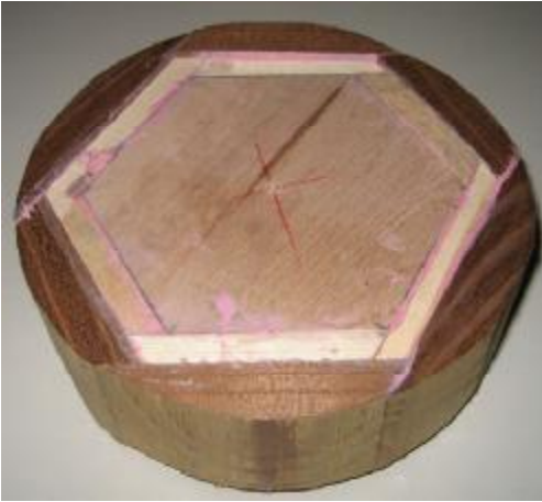
Resim 1.9: Parçaların altıgen bir parça çevresine üst üste yapıştırılması ve elde edilen kompozisyon
