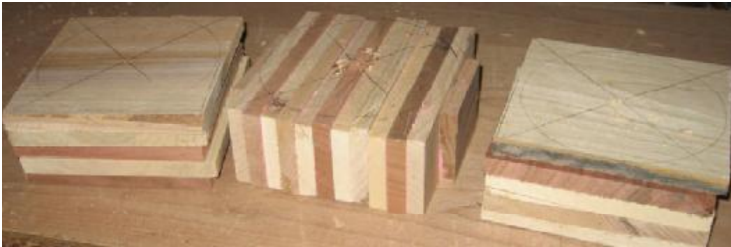
Resim 1.4: Tornalanacak parçaların değişik konumda yapıştırılması
