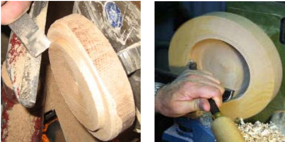
Resim 2.3: Üniversal aynaya baėlanacak kısmın oluřturulması
