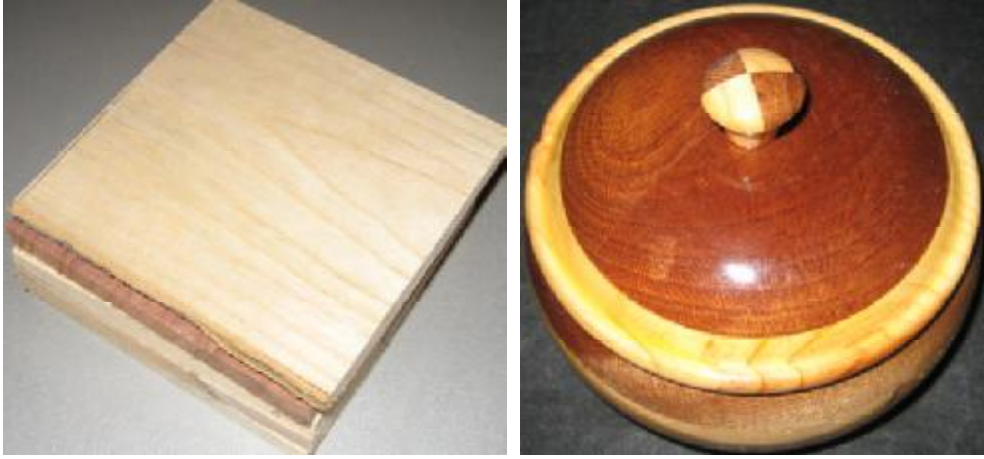
Resim 1.6: Parçaların üst üste yapıştırılması ve elde edilen kompozisyon
