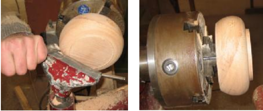
Resim 1.17: Dışbükey tornalama ve ayaklar arasına bağlanacak kısmın oluşturulması
