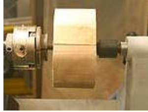
Resim 1.14: Alın tornalanacak parçaların puntalar arasına bağlanması
