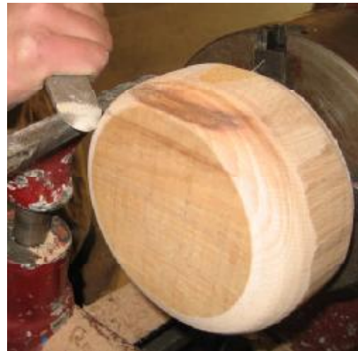
Resim 1.16: Alın tornalanacak parçaların üniversal aynaya bağlanması
