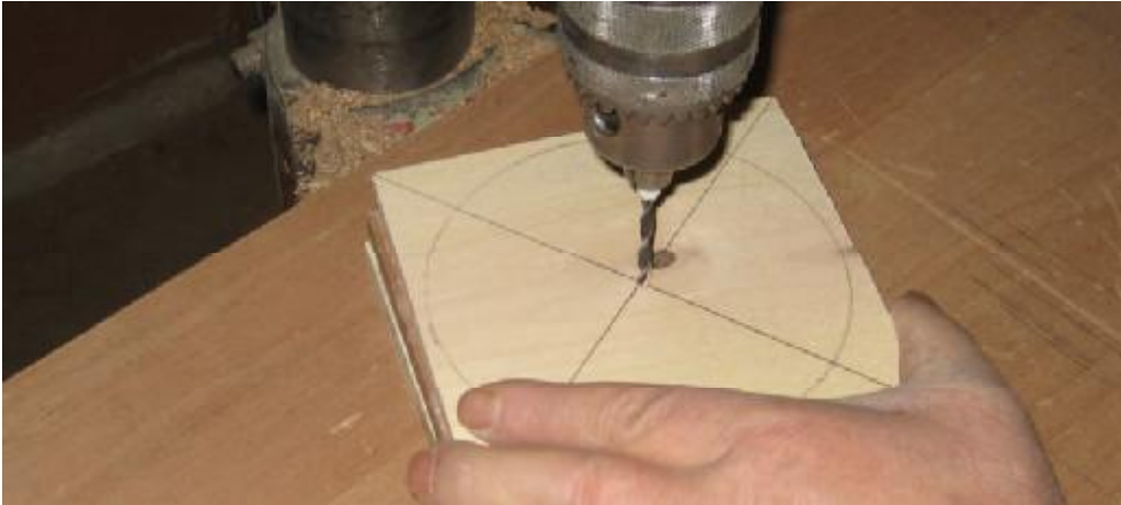
Resim 1.13: İş parçasının merkezinden delinmesi
